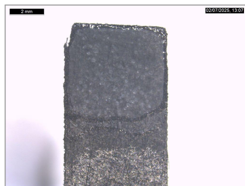
Figura 2. Microscopía de las capas funcionales sobre el electrodo de papel Toray para el biosensor de \text{K}^+ .
