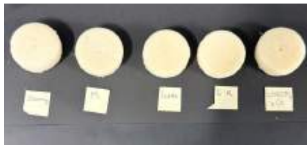
Fig. 1. Estructuras porosas (aerogeles) obtenidas tras el secado del hidrogel.
