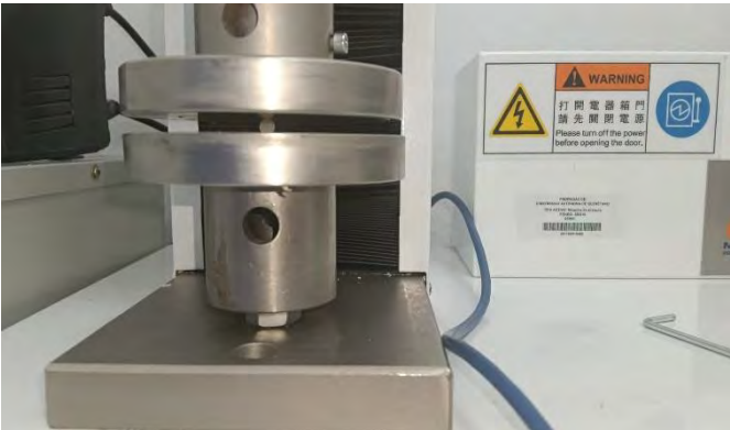
Figura 6. Detalle de las prensas de la maquina universal de pruebas
