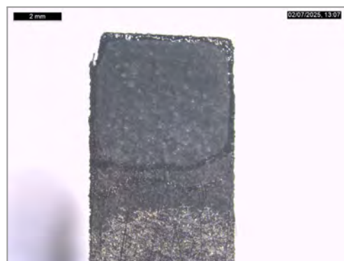
Figura 2. Microscopía de las capas funcionales sobre el electrodo de papel Toray para el biosensor de \text{K}^+ .
