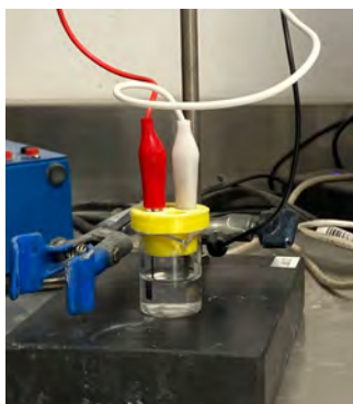
Figura 1. Montaje de la celda electroquímica para las pruebas potenciométricas.
